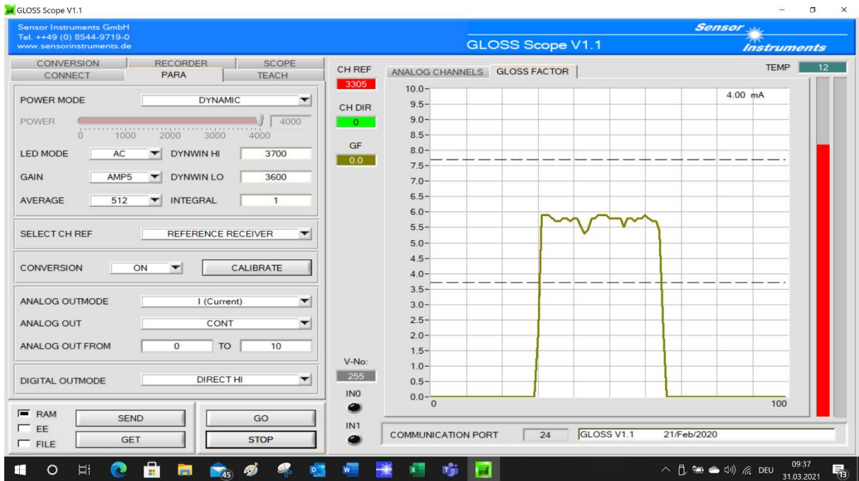
Parametrización del sensor GLOSS y monitores del nivel de brillo (GF).
