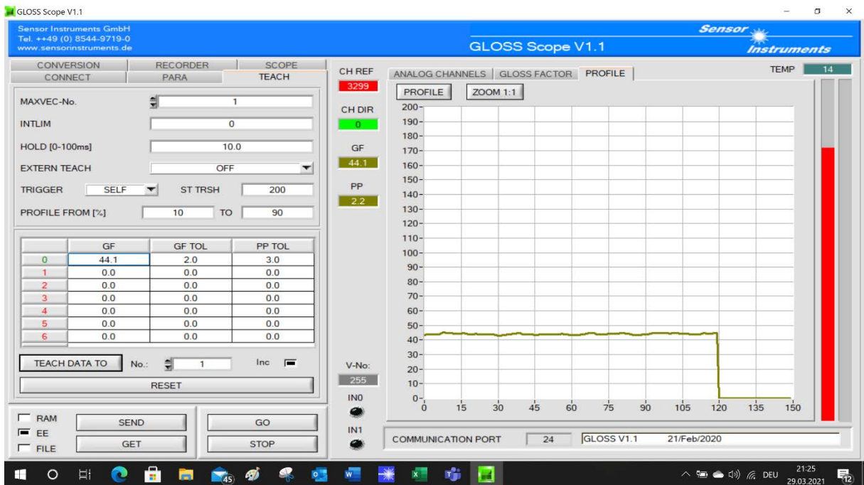
Registro del nivel de brillo con el modo SELF TRIGGER activado.
